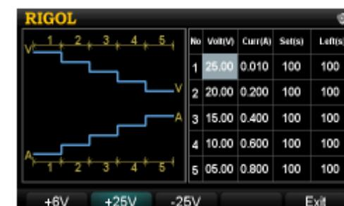
Форму временной зависимости напряжения/тока можно легко наблюдать в режиме реального времени на дисплее источника с помощью функции отображения формы сигнала. Возможность отображения на дисплее формы напряжения, тока и мощности позволяет легко отслеживать текущее состояние выхода.
