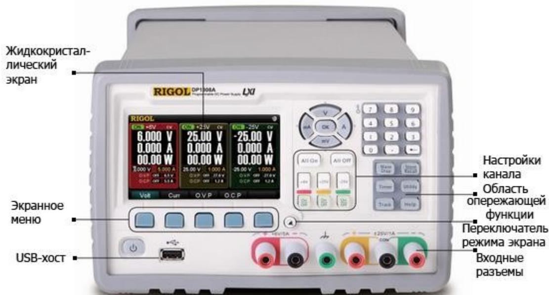
Габариты прибора: 155 мм (высота) x 235 мм (ширина) x 384 мм (глубина), вес 8,5 кг
