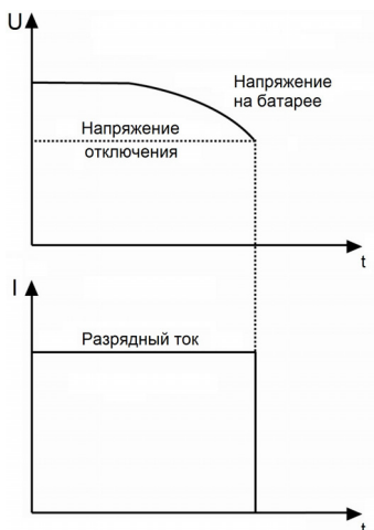
Рисунок 2-10. Процедура проверки батареи на разряд
