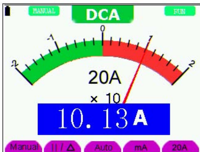
Рисунок 28. Измерения постоянного тока до 20А
