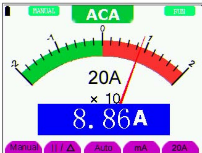
Рисунок 30. Измерение переменного тока до 20А
